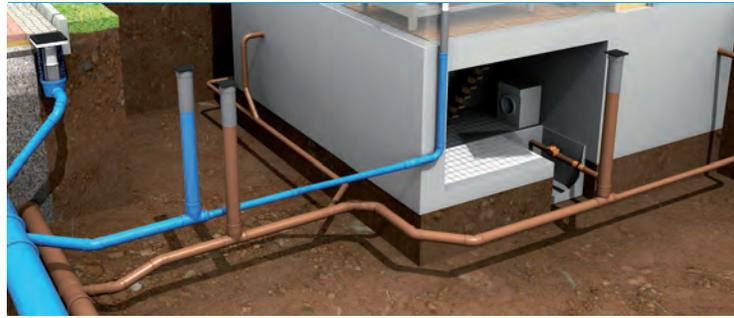
Darstellung der Abwasseranlage eines Hauses: Die blauen Leitungen transportieren das Regenwasser zum Kanal, die braunen das Schmutzwasser.
